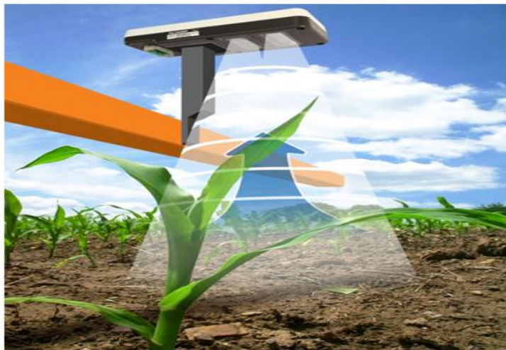
Slika 17. "OptRx" sustav za mjerenje refleksije biljke.
