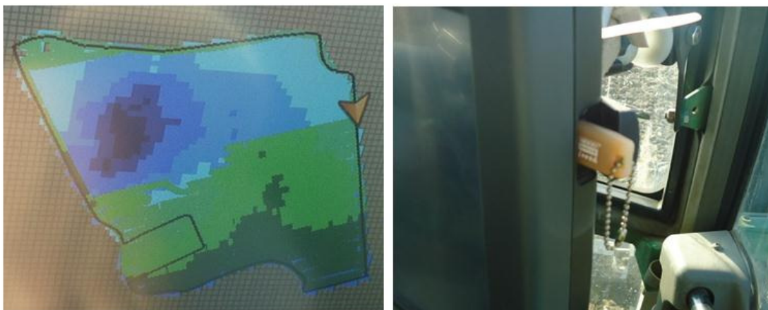
Slika 56. Prikaz karte na zaslonu (lijevo) i USB "stick" za prijenos i dokumentaciju podataka (desno).
