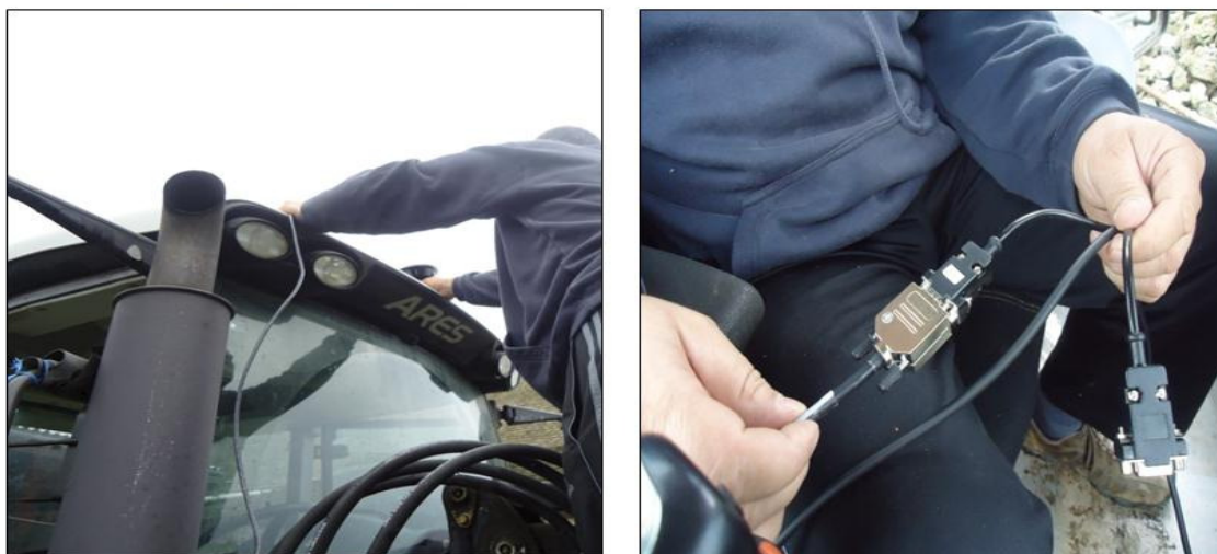
Slika 25. Postavljanje antene na krov kabine traktora (lijevo) i spajanje kablova GPS antene s navigacijskim uređajem (desno).
