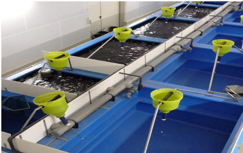
Slika 5- Dizajn RAS-a s četvrtastim spremnicima
