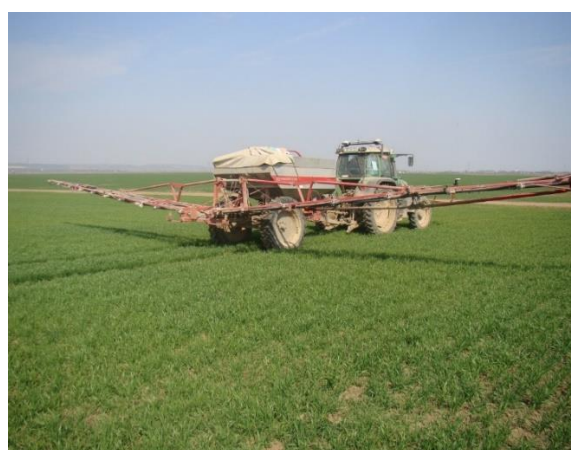
Slika 37. Traktor Fendt 716 Vario sa rasipačem Kongskilde Owerum Wing Jet K-plus Hidro S4024 u prihrani pšenice
