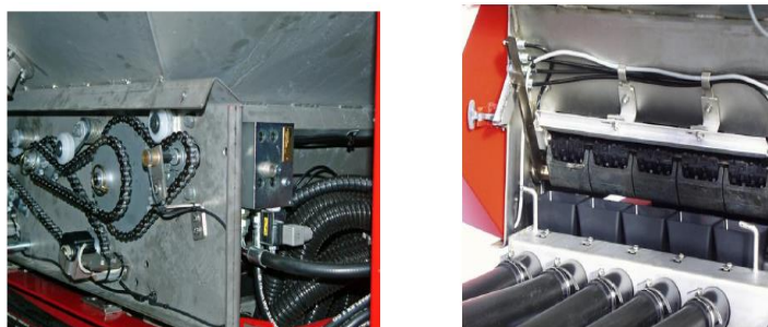
Slika 38. Izgled pogonskog mehanizma i dozirnih valjaka
