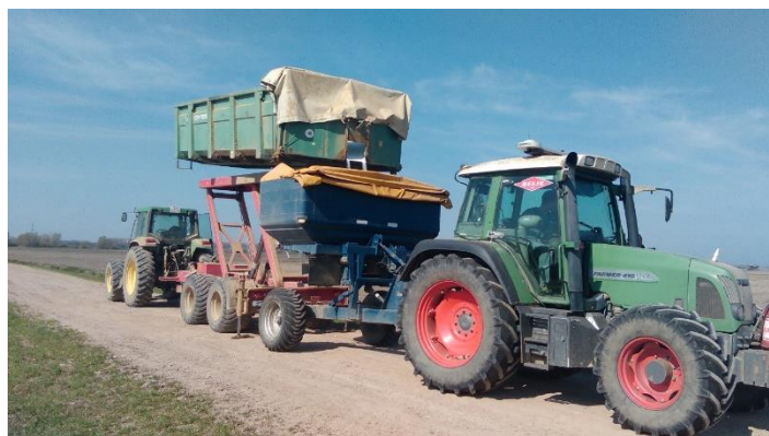
Slika 22. Punjenje rasipača Bogballe mineralnim gnojivom
