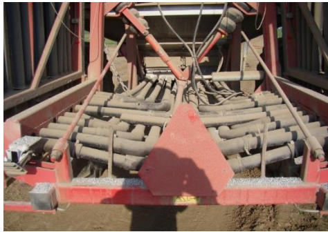
Slika 62. Kongskilde Owerum Wing Jet K-plus Hidro S 4024 izgled hidrauličkog podešavanja (Izvor: P.Marić, 2015.)
