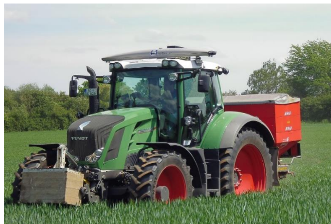
Slika 89. Yara dušični senzori postavljeni na kabinu traktora
