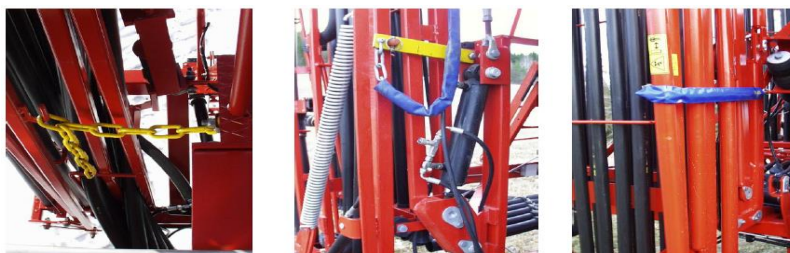
Slika 56. Mehanička transportna kopča za krilo ( 4012, 4020, 4024)
