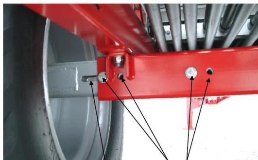
Slika 41. Mjesta podešavanja širine kotača na rasipaču Kongskilde Owerum Wing Jet K-plus
