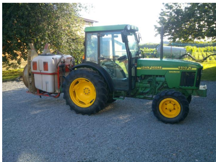
Slika 22. Raspršivač agregatiran s traktorom John Deere 5510 N
