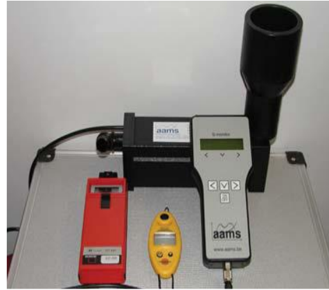
Slika 19. Stolno – elektronski uređaj za mjerenje protoka mlaznica (lijevo) i uređaj za mjerenje protoka AAMS (desno)
