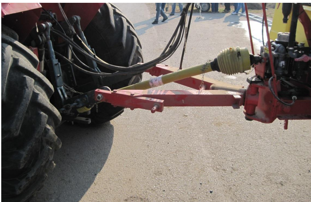
Slika 7. Propisano zaštićeno kardansko vratilo
