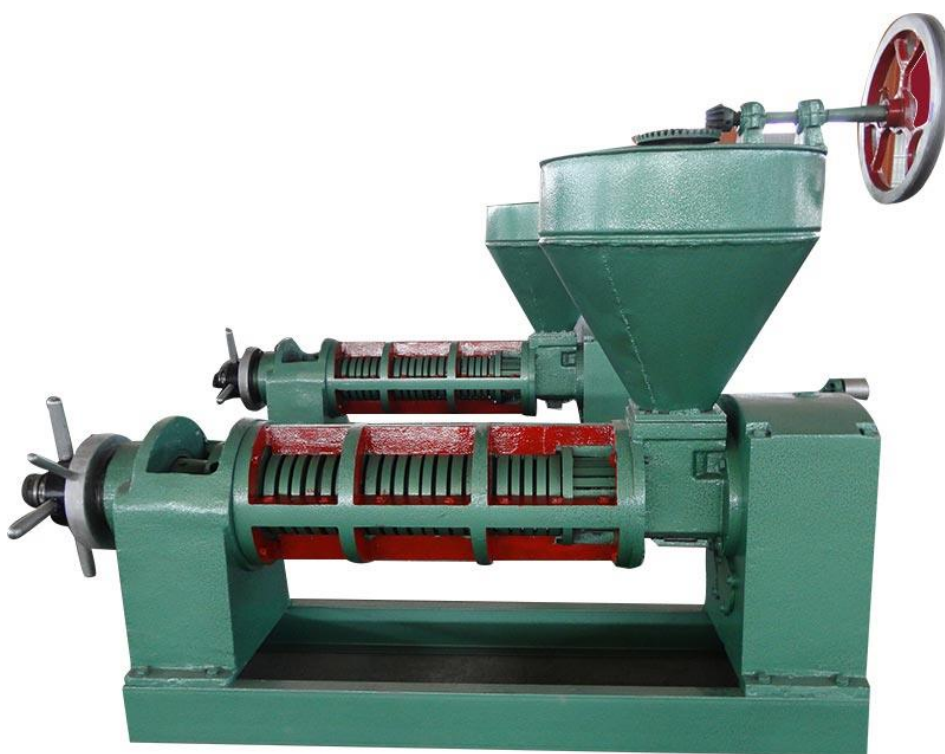
Slika 2 Kontinuirana pužna preša
