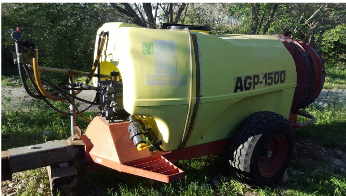
Slika 20. Atomizer marke Agromehanika Kranj (izvor: Autor)
