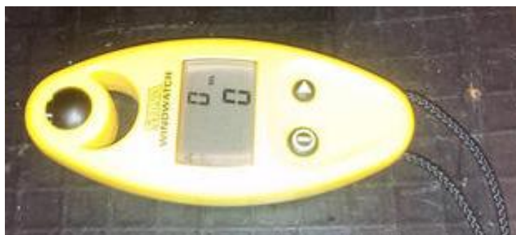
Slika 5. Anemometar Silva Windwatch
