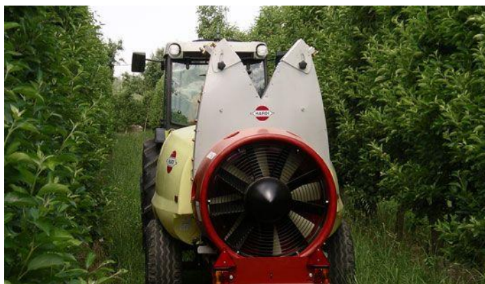
Slika 3. Raspršivač Hardi Zatum
