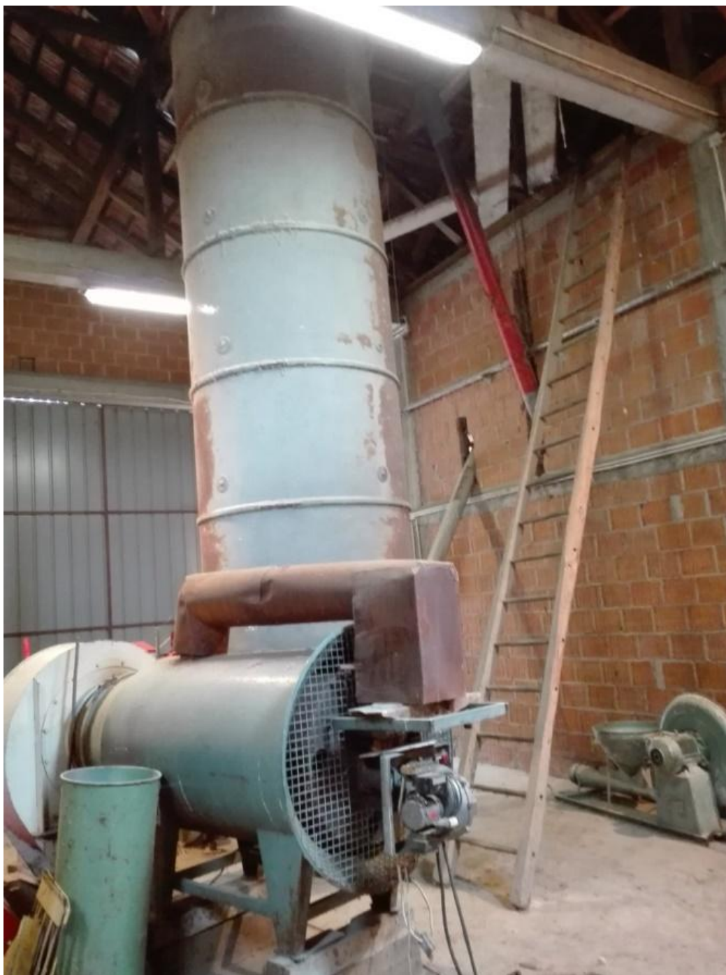
Slika 1. Sušara tipa Neuro volumena 7 tona na OPG-u Ivan Dokladal (izvor: Ivana Dokladal)
