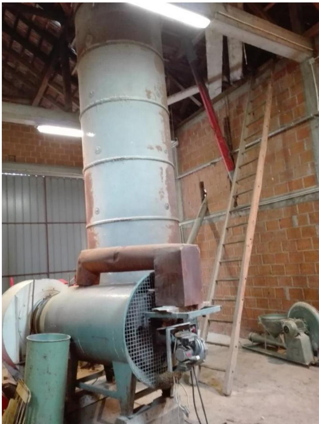
**Slika 1.** Sušara tipa Neuero volumena 7 tona na OPG-u Ivan Dokladal
