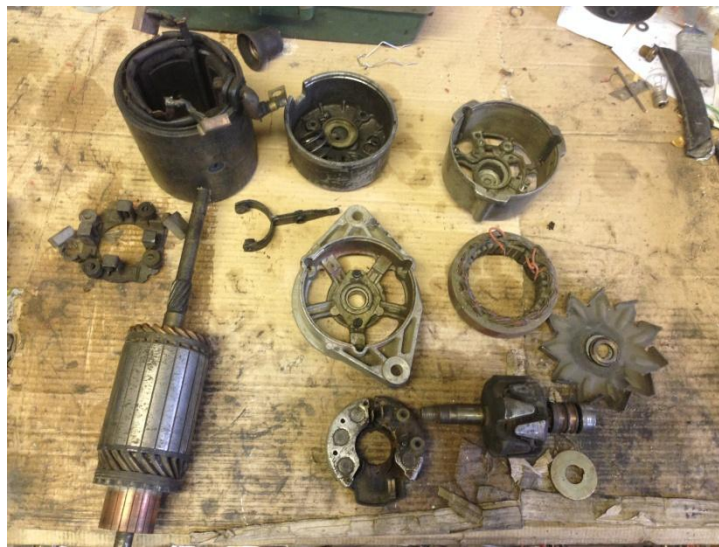
Slika 7. Dijelovi elektropokretača i alternatora
