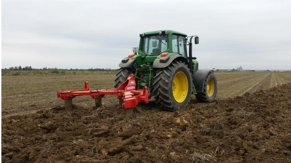
*Slika 4. Dubinska obrada tla podrivačem Quivogne (foto: Trutin)*
