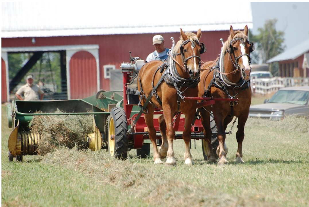
Slika 4. Balirka vučena i indirektno pogonjena konjskom vučom
