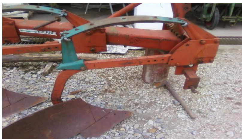
Slika 9. Trobrazdni plug (Izvor: K. Šafran)
