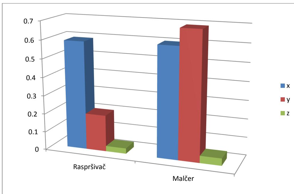
Grafikon 2. Usporedba srednjih vrijednosti mjerena vibracija koje se prenose sa upravljača traktora na sustav ruka - šaka rukovatelja pri radu raspršivača i malčera
