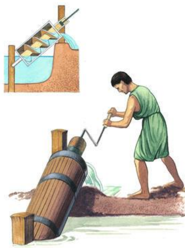
Slika 8. Arhimedov vijak kao pumpa za podizanje vode
