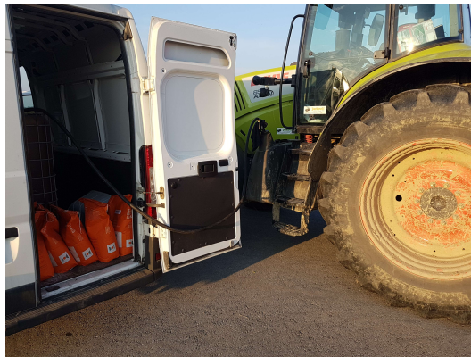
Slika 3. Punjenje spremnika dizel gorivom (Izvor: vlastita fotografija)
