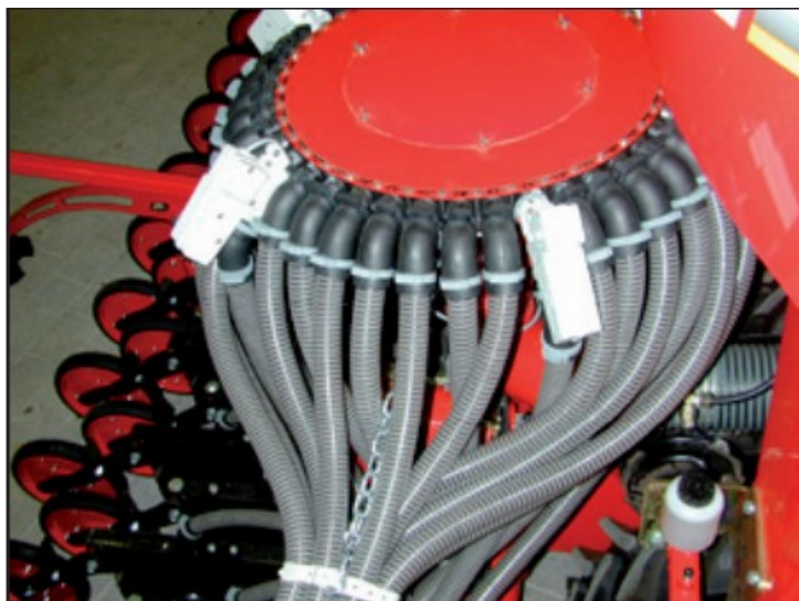
Slika 13. Razvodnik sjemena s magnetnim zaklopkama (Izvor: Uputa za rad, Art.: 80441702 hr)
