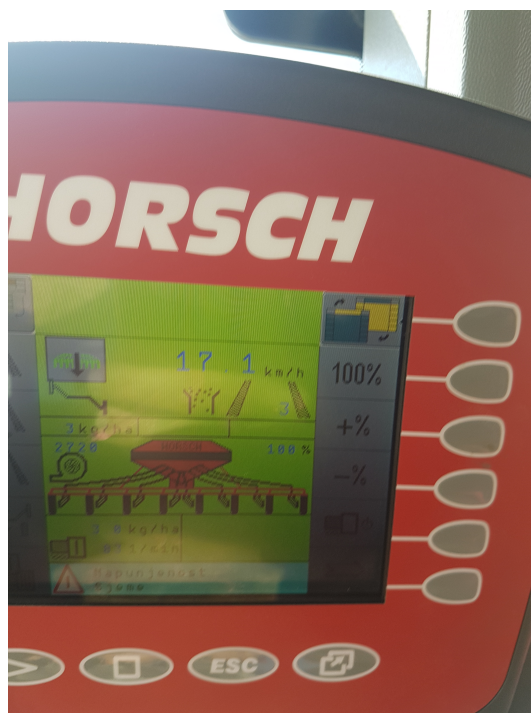
Slika 23. Zaslona računala očitava brzinu kretanja agregata (Izvor: vlastita fotografija)
