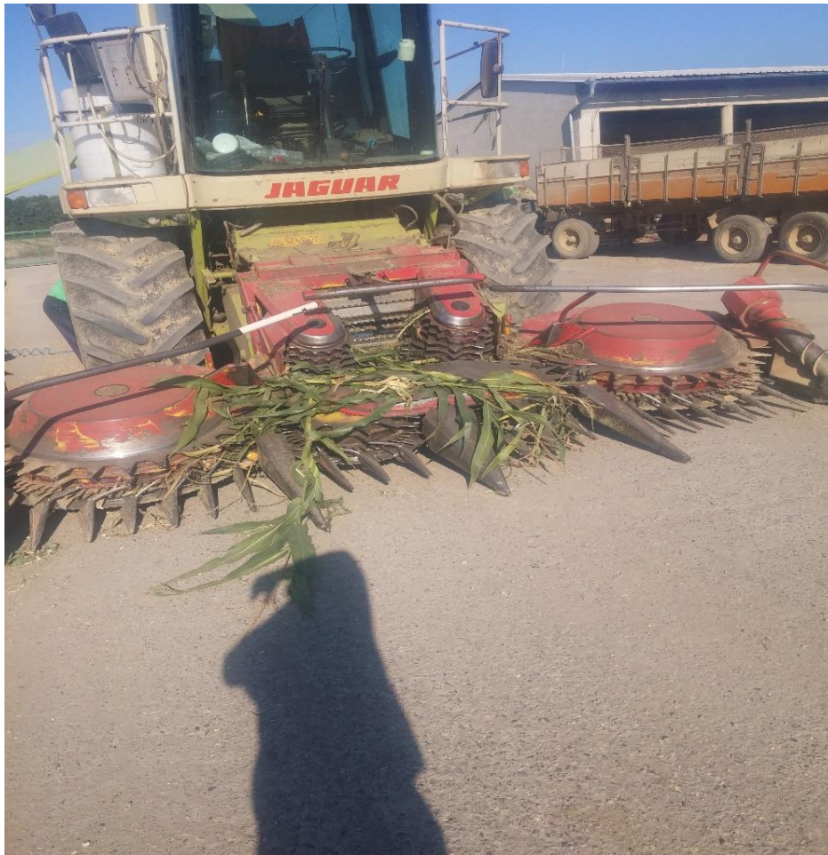
Slika 9. Heder silokombajna u radnom položaju (Izvor : Kolak, I.)
