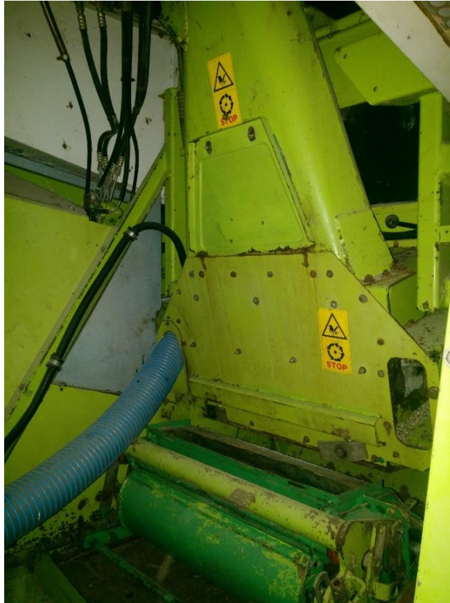
Slika 16. „Vjetar“ sa „corn-crackerom“ (Izvor : Kolak, i:)
