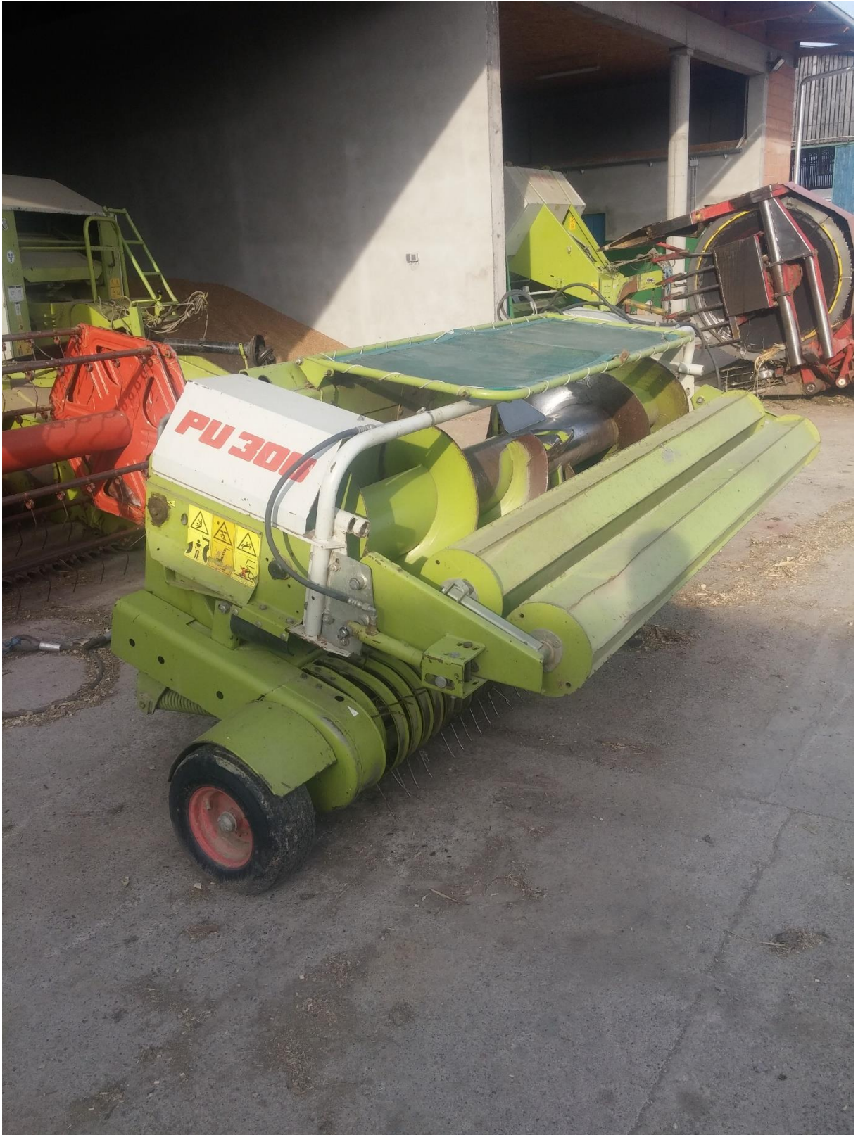
Slika 23. Claasov „Pick-up“ uređaj za sjenažu. (Izvor : Kolak, I.)
