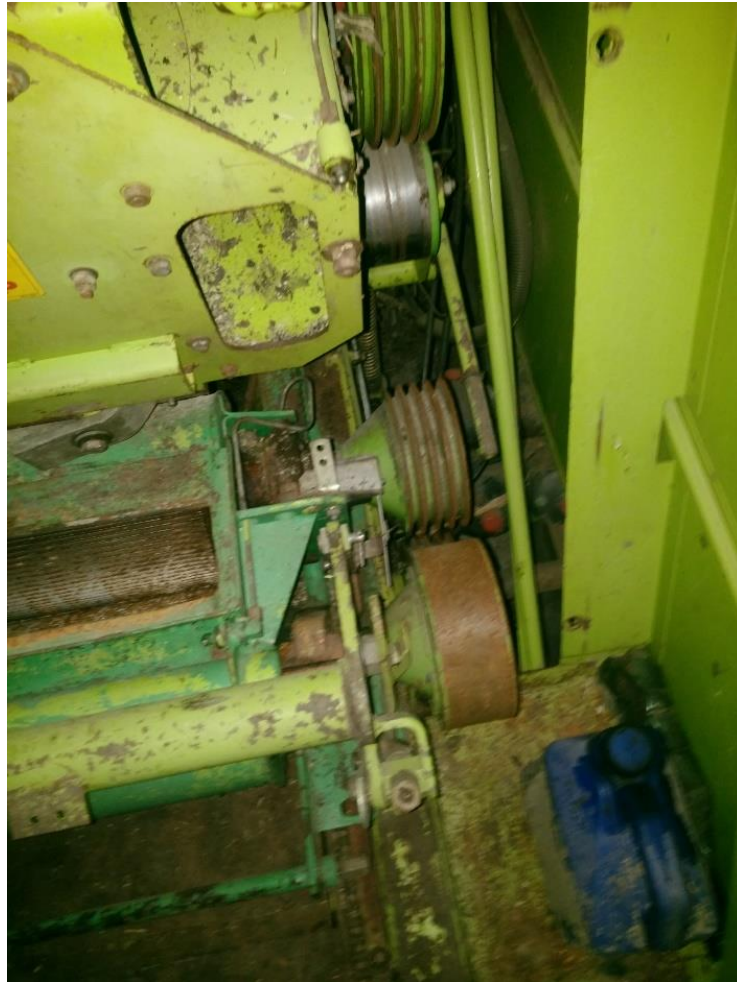
Slika 15. Unutrašnji dio „corn-crackera“ sa valjcima te mjesto na koje ide remen za pogon.
