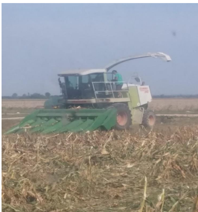
Slika 22. Heder za siliranje klipa kukuruza. (Izvor : Kolak, I.)
