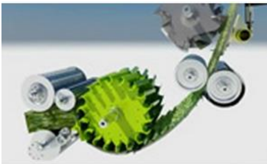
Slika 17. Prikaz rada ubrzivača materijala sa valjcima na grlu i bubanj sa noževima koji sjecka masu. (Izvor : Internet – link 3.)
