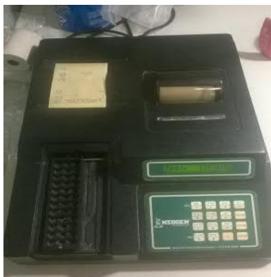
Slika 11. Uređaj ELISA - određivanje mikotoksina (orijentacioni test).
