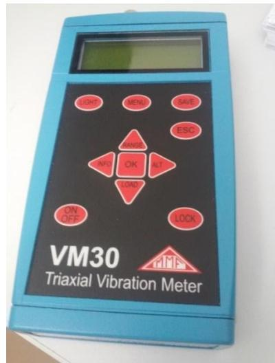
Slika 13. Uređaj za mjerjenje vibracija MMF VM30 (vlastita fotografija)
