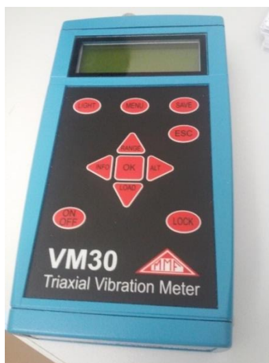
Slika 13. Uređaj za mjerenje vibracija MMF VM30 (vlastita fotografija)
