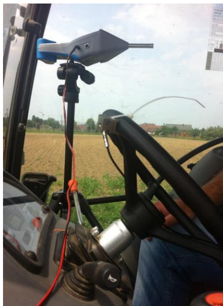
Slika 12. Položaj akcelerometra na kolu upravljača stroja (vlastita fotografija)
