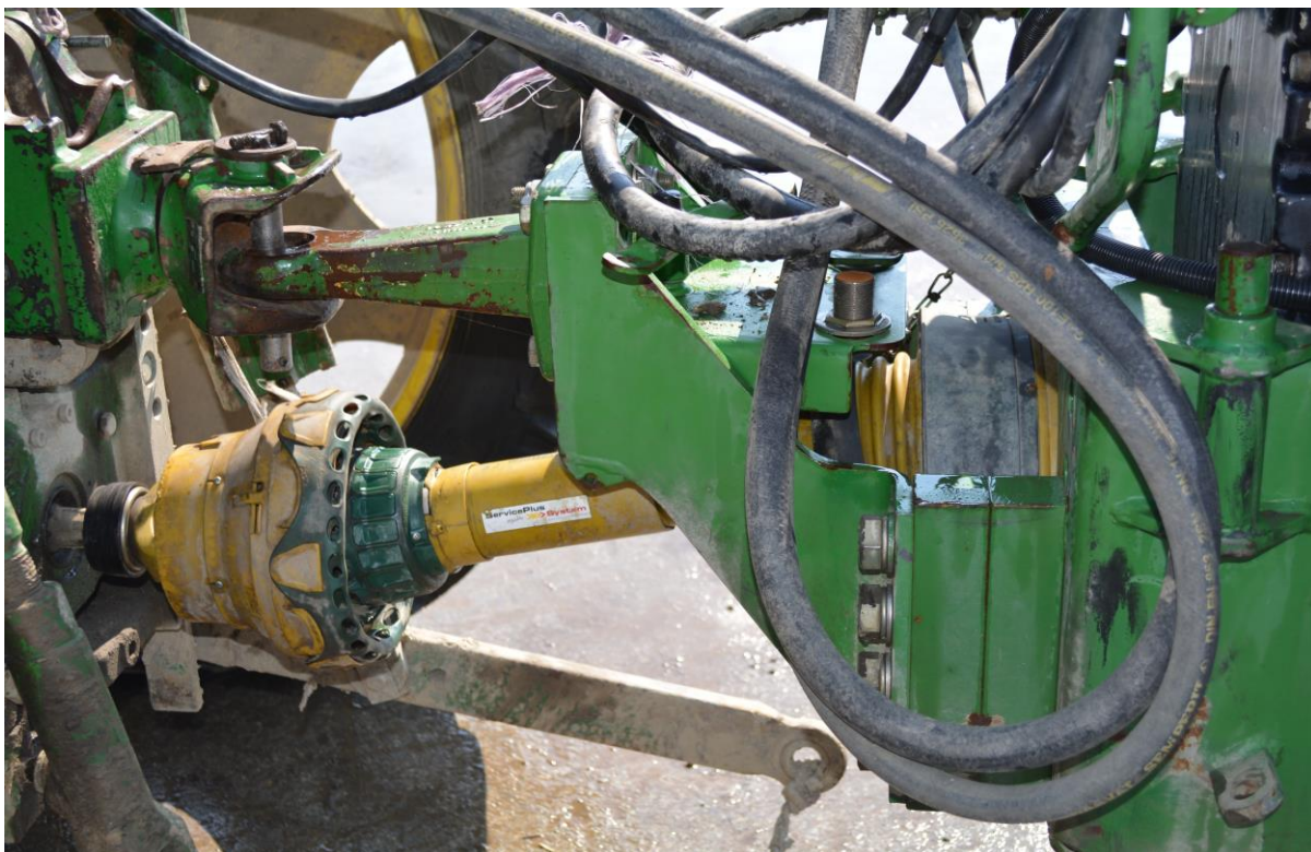
Slika 8. Pravilna zaštita PVT – a na prskalici tvrtke John Deere
