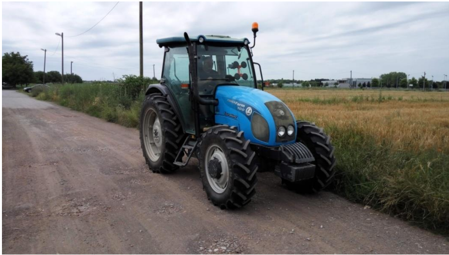
Slika 8: Mjerenje razine traktorski vibracija na makadamu (vlastita fotografija)
