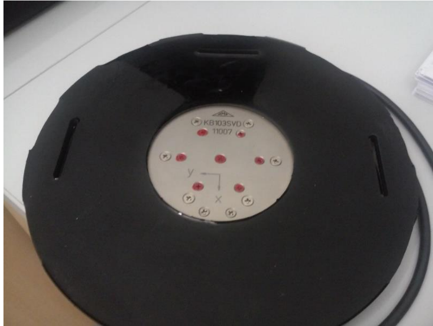
Slika 10: Prikaz pravca mjerenja za osi x, y i z (vlastita fotografija)
