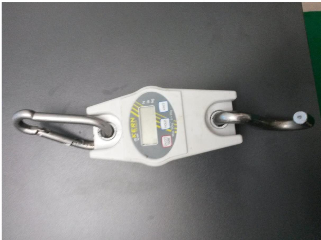
**Slika. 13.** Digitalna vaga za mjerenje mase uzoraka ( Autor, 2016. )
