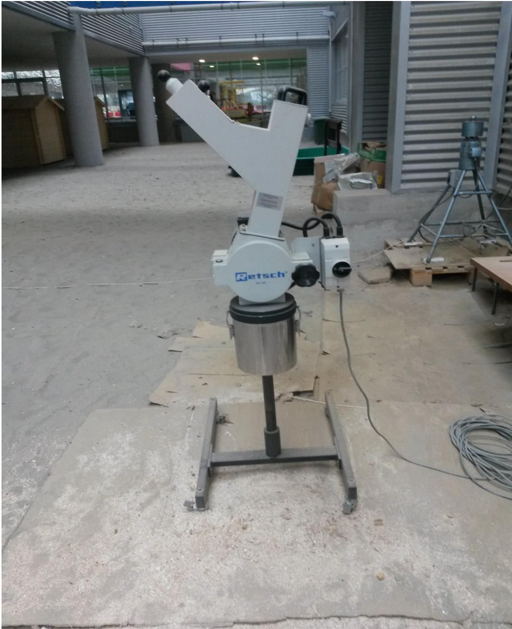
Slika.15. Mlin za usitnjavanje rozgve ( Autor, 2016. )
