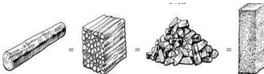
**Slika.1.** Usporedba zapremine različitih drvnih goriva
