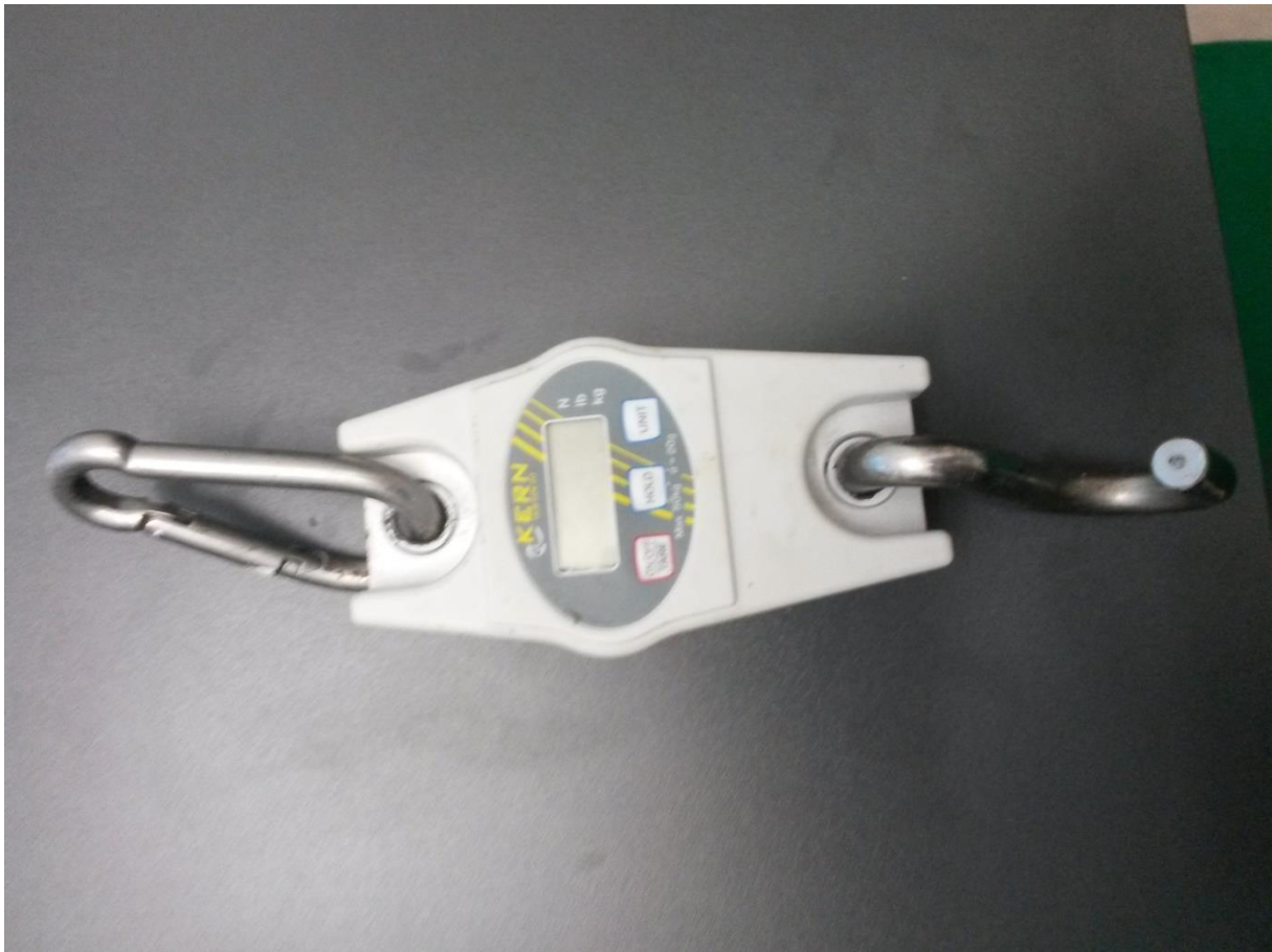
Slika. 13. Digitalna vaga za mjerenje mase uzoraka ( Autor, 2016. )
