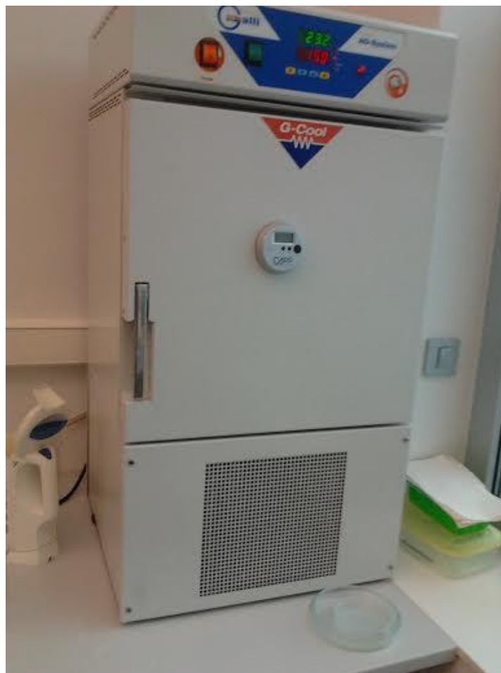
Slika 7. Komora za držanje uzoraka na 15 °C (foto Matija Kubala)
