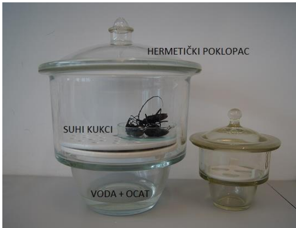
Slika 50. Eksikator za omekšavanje (Foto: Rudnički, I., 2016.)
