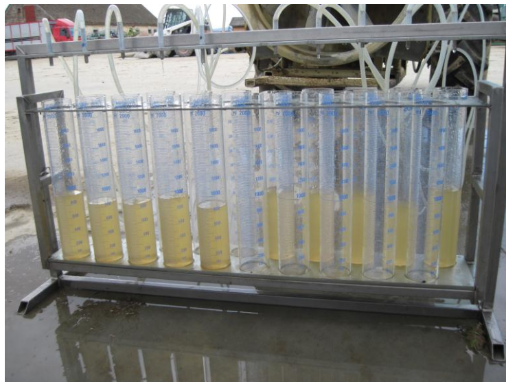
Slika 16. Testiranje protoka mlaznica i raspodjele tekućine
