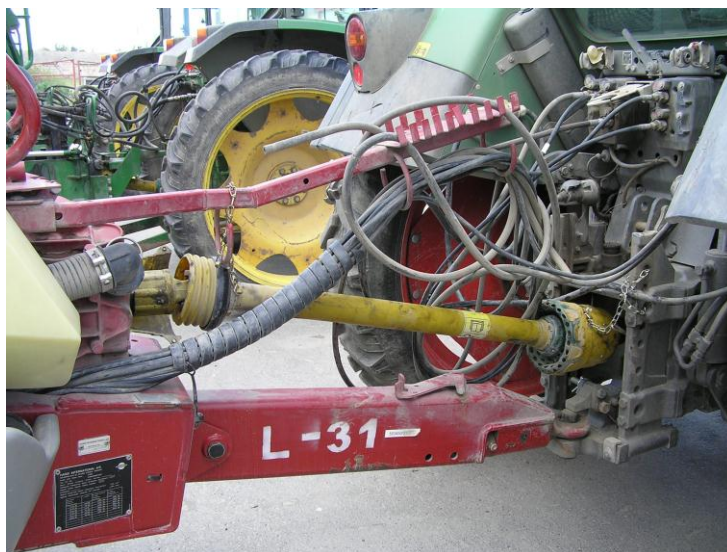
Slika 10. Pravilno postavljena zaštita priključnog vratila
