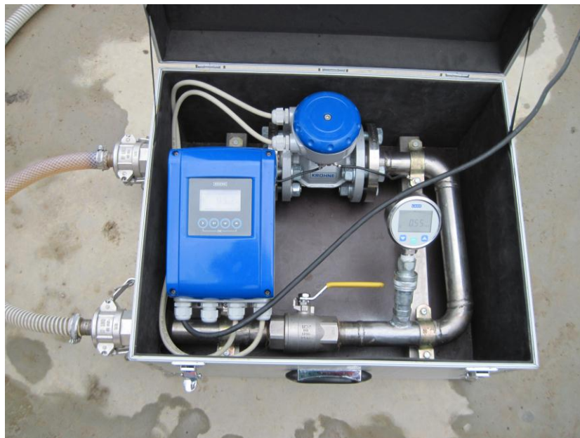
Slika 14. Uređaj za kontrolu protoka crpke Krohne
