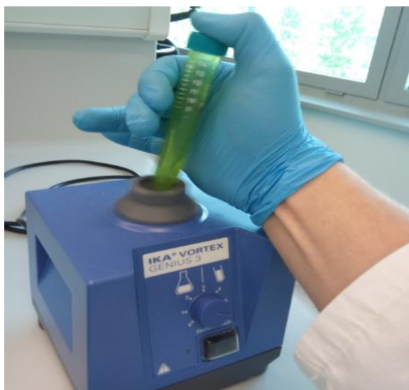
Slika 4. Miješanje uzorka tkiva na vrtložnoj treskalici.
