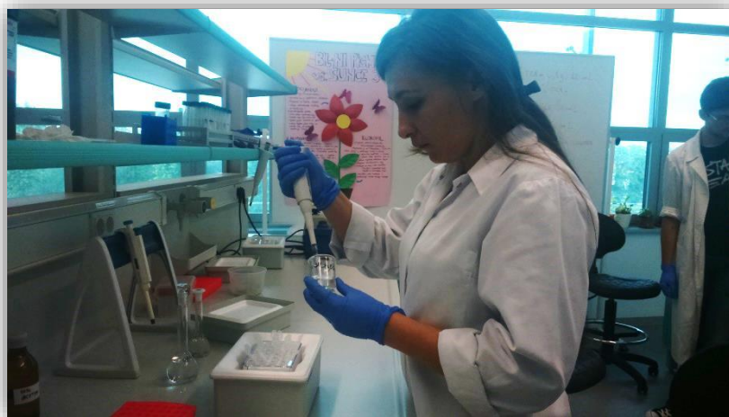
Slika 4. Otapanje supernatanta s 2\text{M H}_2\text{SO}_4 kod određivanja sadržaja vodikovog peroksida
