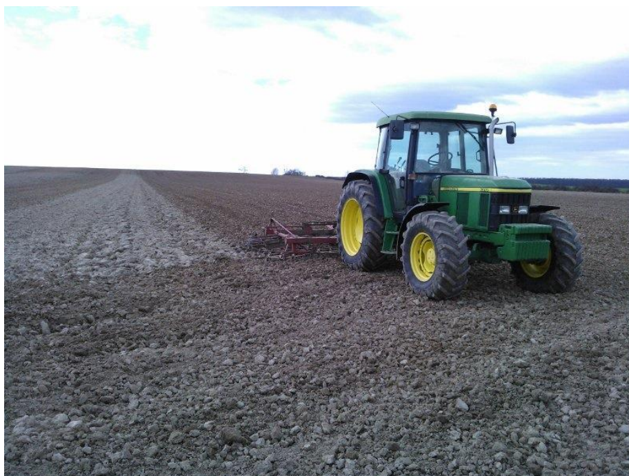
Slika 6: Zatvaranje vlage drljačom (Izvor: M. Mihaljević)
