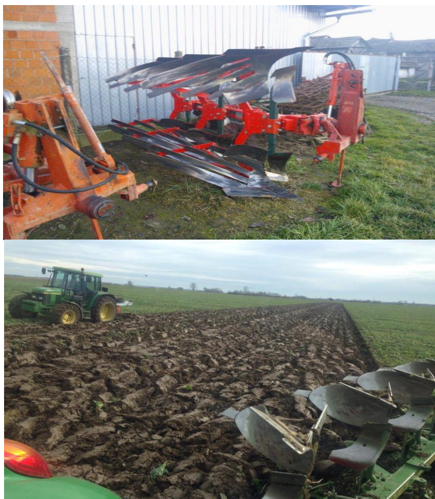
Slika 5: Oranje plugom premetnjakom (Izvor: M. Mihaljević)
