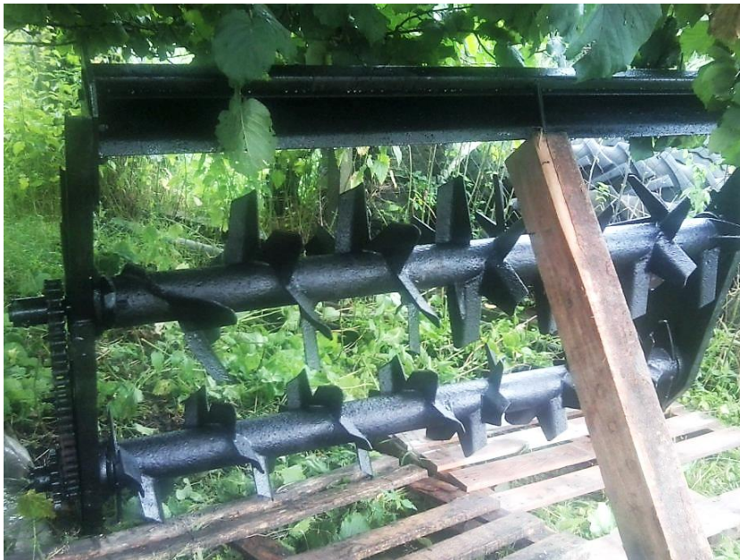
Slika 41. Uređaj za razbacivanje krutog stajskog gnojiva zaštićen bojom (foto: I. Andrić)
