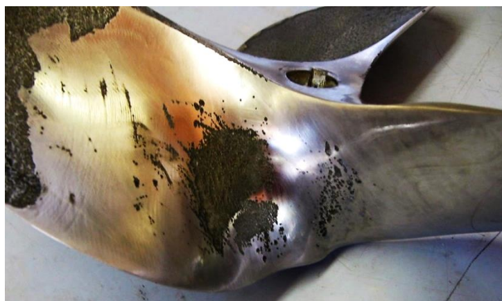
Slika 19. Kavitacijska korozija broskog vijka
