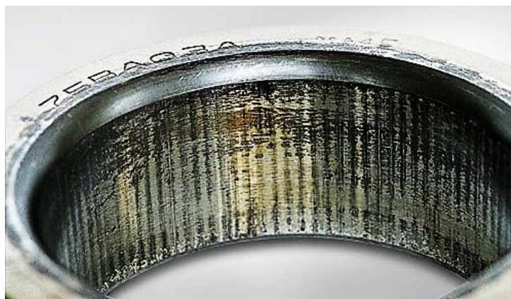
Slika 20. Tarna korozija vanjskog prstena kotrljajućeg ležaja
