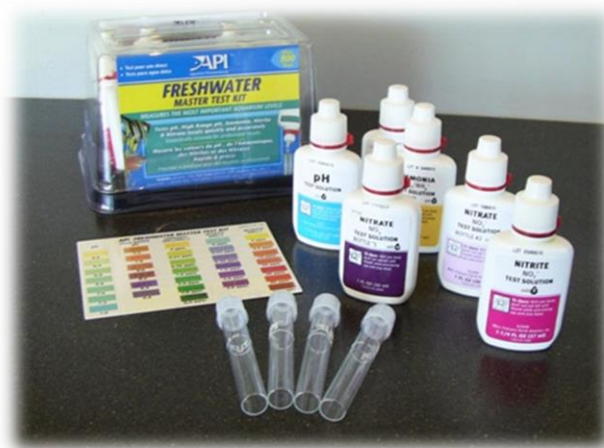
Slika 22: kit za mjerenje koncentracije amonijaka, nitrita, nitrata, pH, high range pH Izvor: autor
