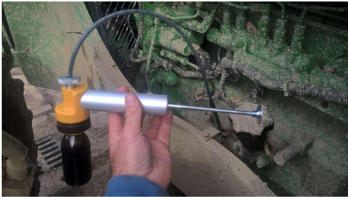
Slika 7. Crpka za izuzimanje uzoraka ulja, vlastita fotografija
