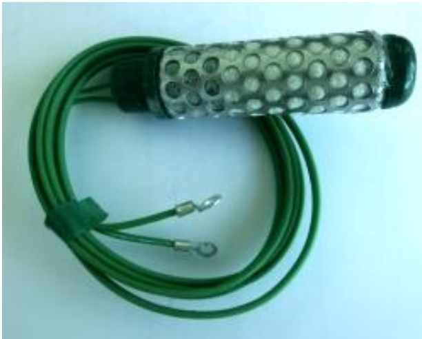
Slika 9. Granular matrix senzor (Foto: M. Marković)
