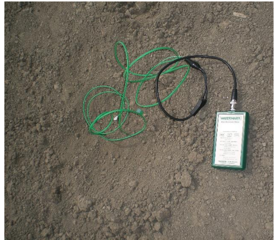
Slika 10. Watermark uređaj (Foto: M. Marković)
