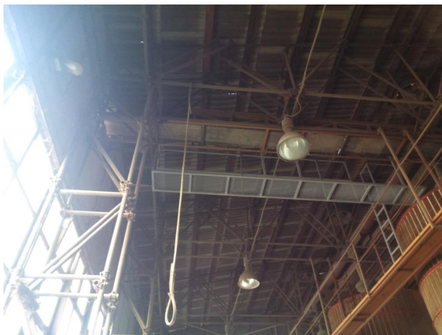
Slika 7. Traka od elevatora do trake koja raspoređuje klip u koševima (vlastita fotografija)
