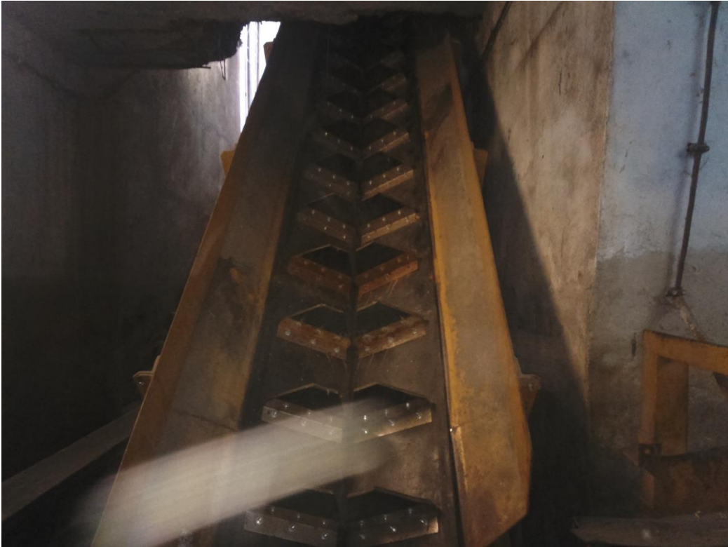
Slika 3. Transportna traka od prebirnog stola ka traci koja vodi do elevatora (vlastita fotografija)
