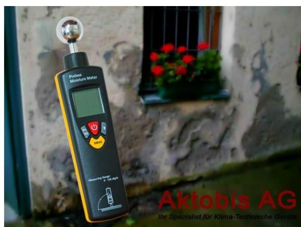
Slika 3. Uredaj za mjerjenje vlage u objektu (Izvor:[www.proluft.hr](http://www.proluft.hr))
