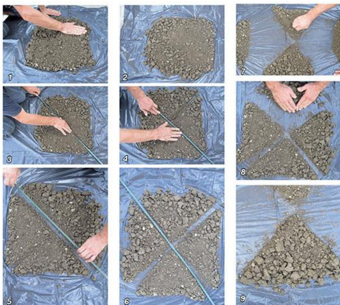
Slika 3. Priprema prosječnog uzorka „čtvrtnjem“
