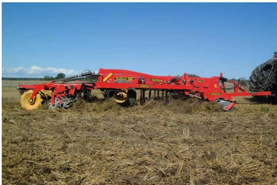
Slika 6. TopDown, stroj za reduciranu obradu tla ( http://www.vaderstad.com )
