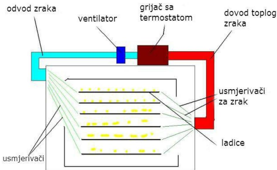
Slika 1. Shematski prikaz strujanja zraka u sušari
