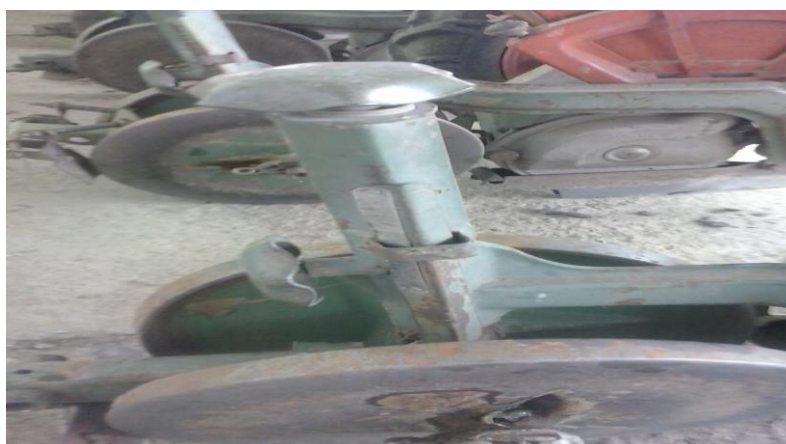
Slika 16. Ručica za podešavanje dubine sjetve.
