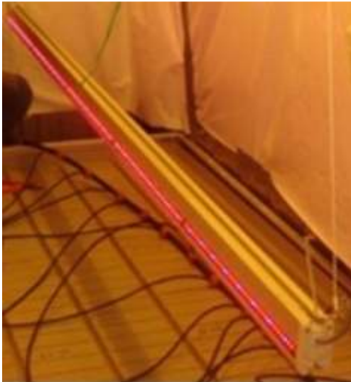
Slika 26. LED lampa snage 114 W. Philips lightening GreenPower. Pruža spektar crvene i plave svjetlosti. Autorska fotografija
