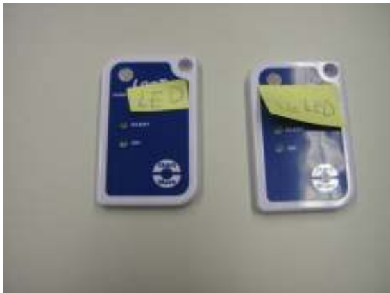
Slika 29. Log Tag model: HAXO-8, uređaj za mjerenje temperature i relativne vlažnosti. Autorska fotografija.
