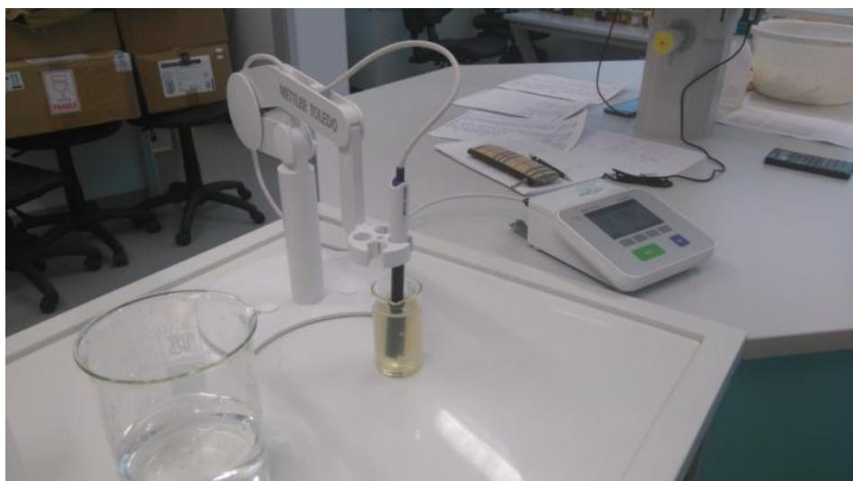
**Slika 31.** Mjerenje električne vodljivosti
