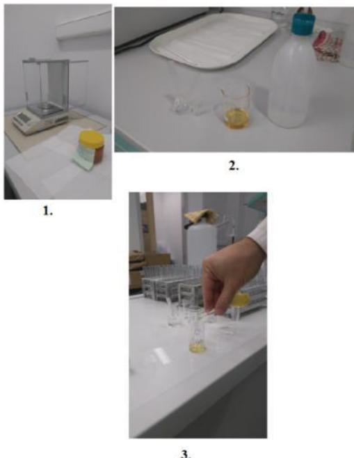
**Slika 36.** Priprema uzorka za DPPH metodu
