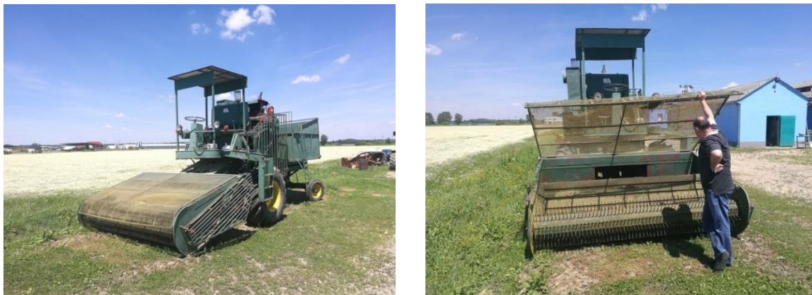
Slika 4. Samohodni berač kamilice (detaljan prikaz) ( Foto original )
