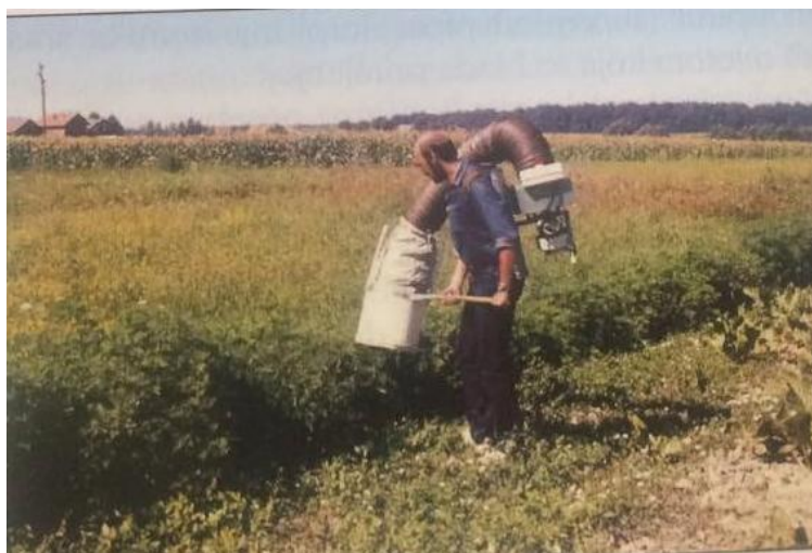
Slika 2. Leđni usisavač Di Vak
