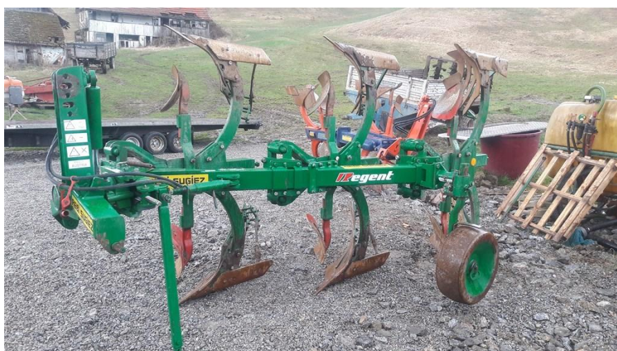
Slika 7. Uređaj za primjena granula u brazdu
