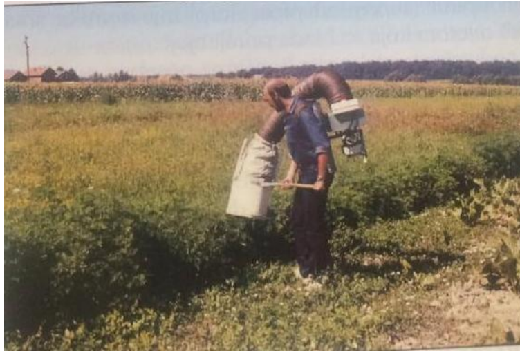
Slika 2. Leđni usisavač Di Vak
