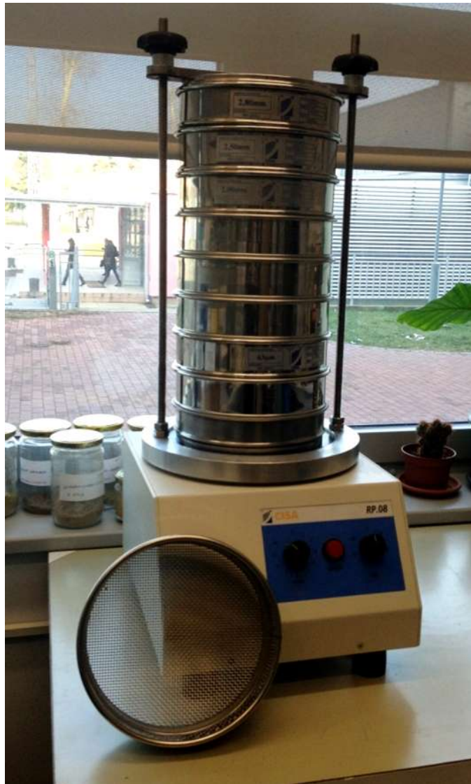
Slika 3. Elektromagnetska tresilica za prosijavanje CISA RP08 \varnothing 200/203 (Foto: Vlatka Rozman)
