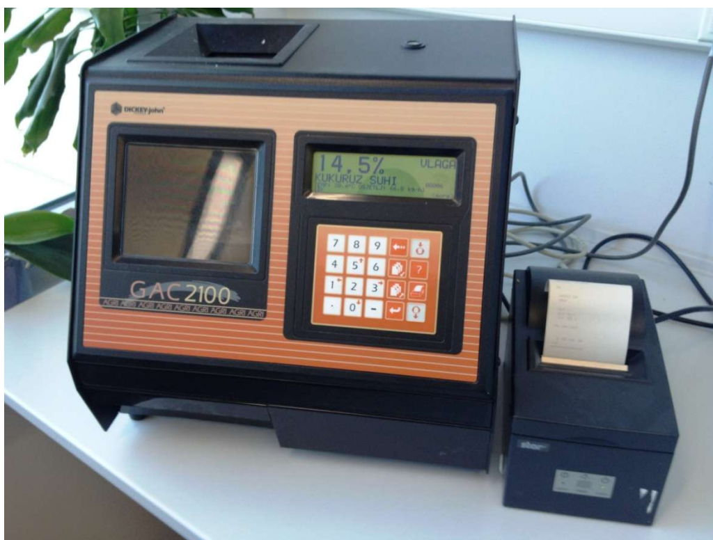
Slika 2. Uređaj za mjerenje vlage, temperature i hektolitarske mase zrna s pisačem DICKEY-john® GAC 2100 (Foto: Vlatka Rozman)
