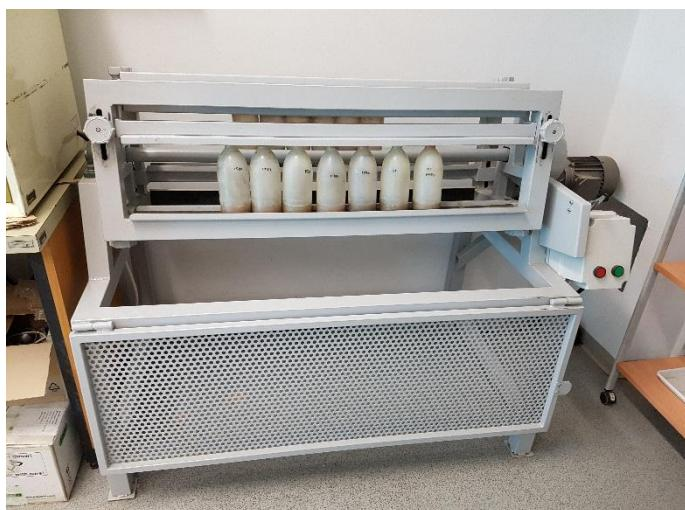
Slika 6. Mućkanje suspenzije tla na rotacijskoj mućkalici
