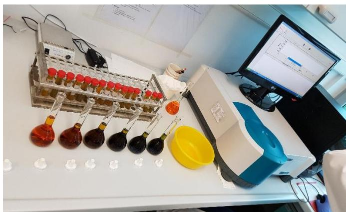
Slika 5. Spektrofotometrijsko određivanje organskog ugljika
