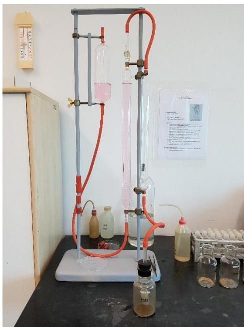
Slika 9. Određivanje sadržaja karbonata u tlu Scheiblerovim kalcimetrom
