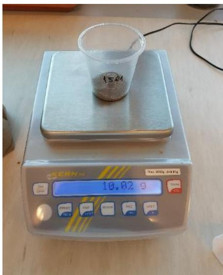
Slika 1. Odvagivanje 10 g uzorka tla
