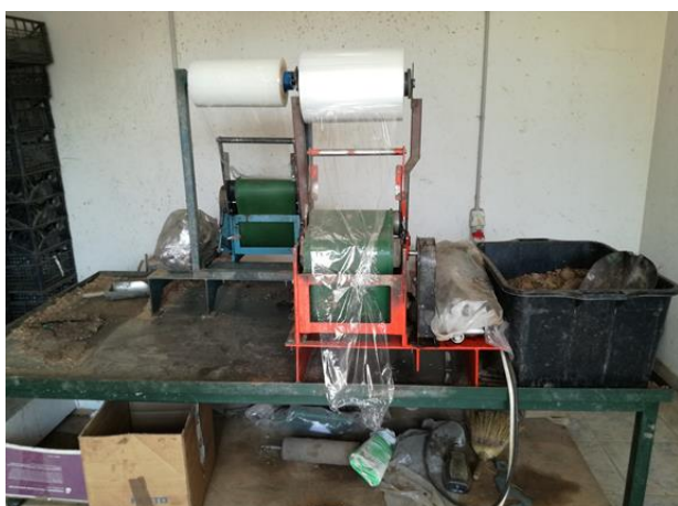
Slika 29. Stroj za pakiranje ( fotografija, I. Kovačević )
