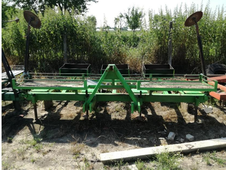
Slika 26. Četveroredna sadilica – ručni rad (fotografija, I. Kovačević )
