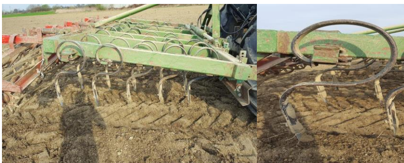
Slika 14. Prikaz a) radnih organa Pecka sjetvospremača „S opruge“ i b) sjetvospremač Pecka sa „S oprugama“ (Izvor slike: Goran Mandić)
