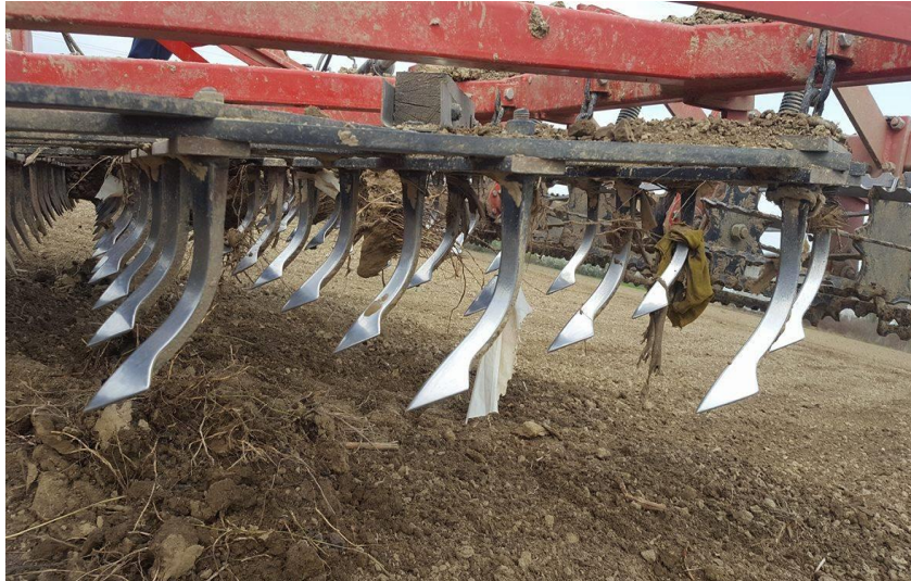
Slika 15. Prikaz radnih organa sjetvospremača „pačje noge“ (Izvor slike: Goran Mandić)
