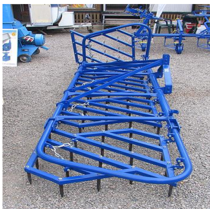
Slika 11. Prikaz klinaste drljače kao zasebnog priključaka (Izvor slike: https://sr.wikipedia.org/sr-el/%D0%94%D1%80%D1%99%D0%B0%D1%87%D0%B0(%D0%BE%D1%80%D1%83%D1%92%D0%B5) )
