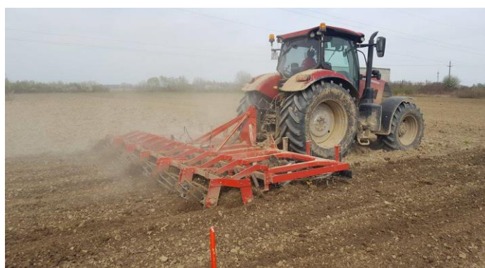
Slika 16. Prikaz sjetvospremača sa „pačjim nogama“ u radu (Izvor slike: Goran Mandić)
