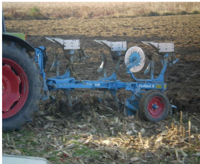
Slika 2. Prikaz jesenskog dubokog oranja plugom Lemken Opal 110 (Izvor slike: Goran Mandić)
