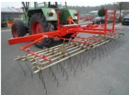
Slika 12. Prikaz drljače pljevilice (Izvor slike: <http://www.traktorpool.com.hr/rabljeno/a-Obrad-tla/4/b-Zup%C4%8Dasta-pljevilica/176/c-Sonstige/0/>)
