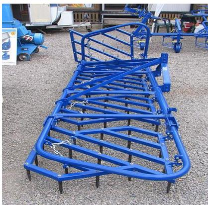
Slika 11. Prikaz klinaste drljače kao zasebnog priključaka (Izvor slike: [https://sr.wikipedia.org/sr-el/%D0%94%D1%80%D1%99%D0%B0%D1%87%D0%B0 \(%D0%BE%D1%80%D1%83%D1%92%D0%B5 \)](https://sr.wikipedia.org/sr-el/%D0%94%D1%80%D1%99%D0%B0%D1%87%D0%B0 (%D0%BE%D1%80%D1%83%D1%92%D0%B5 )))
