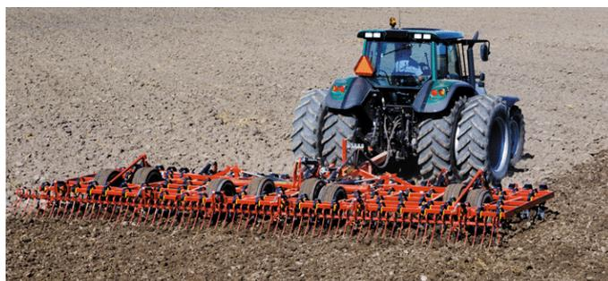
Slika 18. Prikaz vučenog sjetvospremača (Izvor slike: <http://www.pmt.hr/hr/mehanizacija/obrada-tla-i-sjetva/10/>)
