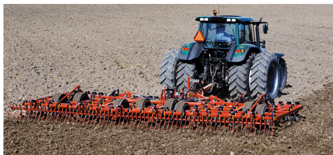
Slika 18. Prikaz vučenog sjetvospremača (Izvor slike: http://www.pmt.hr/hr/mehanizacija/obrada-tla-i-sjetva/10/ )
