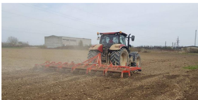
Slika 17. Prikaz nošenog sjetvospremača (Izvor slike: Goran Mandić )
