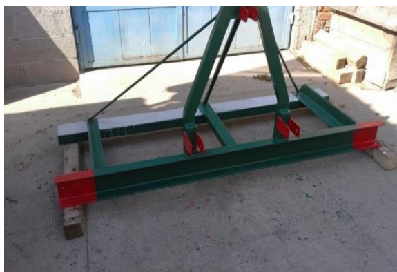
Slika 10. Prikaz ravnjača daske kao zasebnog priključaka (Izvor slike:
